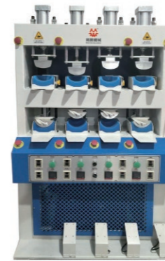
MT-627 Máy Tạo Hình Ngược Mũi Giày Bốn Lạnh Bốn Nóng Reversed toe forming machine (4-cold 4-hot)
