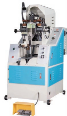
MT-58A Máy Ép Gót Thủy Lực Tự Động (Chuyên Giày Nữ) Computer Memory Control Automatic Side & Hell Seat Lasting Machine(For women's shoes)
