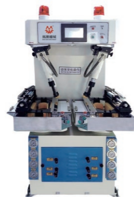
MT-817-D Máy Ép Đế Thủy Lực Đa Năng Hoàn Toàn Tự Động Fully Automatic Universal Wall Type Sole Pressing Machine
