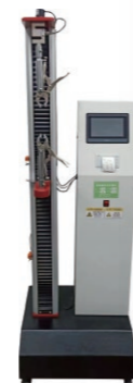
MT-9020 Máy Kiểm Tra Lực Kéo Thành Phẩm Finished Shoe Tensile Testing Machine
