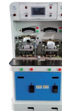
MT-623 Máy Tạo Hình Mũi Giày Hai Lạnh Hai Nóng Double Cold And Double Hot Shoe Toe Shaping Machine
