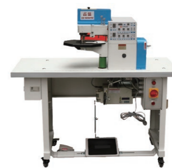
MT-929 Máy Dán Keo và Gấp Biên Tự Động Automatic Folding Edge Glue Machine
