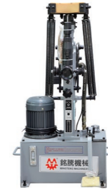
MT-802B Máy Tháo Giày Thành Phẩm Dạng Thủy Lực Oil Pressure Release Shoe Last Machine
