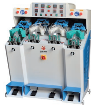
MT-622DB Máy Tạo Hình Gót Kiểu Ngang Hai Nóng Hai Lạnh Horizontal Double Cold Double Heel After Heat Setting Machine
