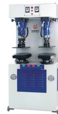
MT-927 Máy Ép Đế Thủy Lực Đáy Lớn Hydraulic Pressure Sole Attaching Machine
