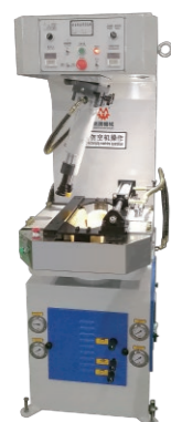
MT-817 Máy Ép Đế Thủy Lực Đa Năng Định Vị Tự Động (Một Mặt) Universal Automatic Positioning The Bottom Of The Hydraulic Pressure Machine (Unilateral)
